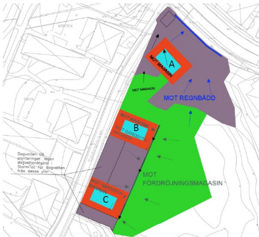
Figur 26: Principskiss över dagvattenhanteringen inom planområdet som redovisar vart dagvattnet avvattnas och på vilka sätt det tas omhand. Kassettmagasin vid förskolegården är markerad med svart rektangel. Fördröjningsmagasin i bergskärning är markerat i grått längs med hus B och C. Bild: ÅF Infrastructure
